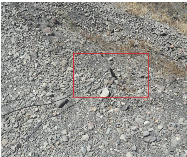
Εικόνα 28: Διαδικασία μέτρησης θερμοκρασία εδάφους σε βάθος περίπου 15cm. Νέα Καμένη, Ιούνιος 2017
