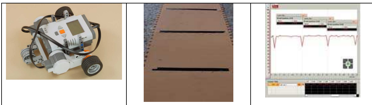
Εικόνα 10: Υπολογισμός ταχύτητας: το ρομπότ, ο διάδρομος πειρατισμού, η γραφική παράσταση
