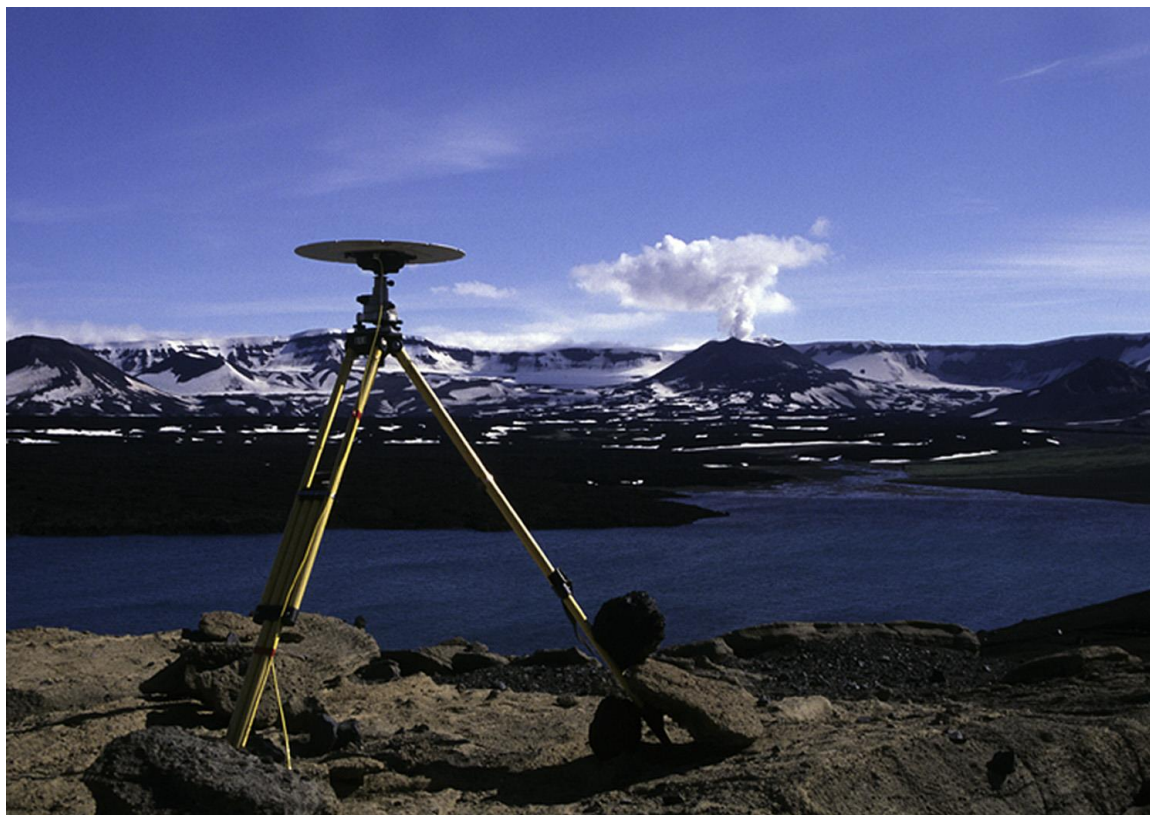
Εικ..55 Δέκτης GPS διπλής συχνότητας Trimble που χρησιμοποιείται μέσα στην καλντέρα του ηφαιστείου Okmok, Νησιά Aleutian, Αλάσκα.Φωτο. J. Freymueller.
