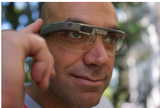
Εικόνα 27: Optical see-through HMD [πηγή: https://en.wikipedia.org/wiki/Head-mounted_display ]
