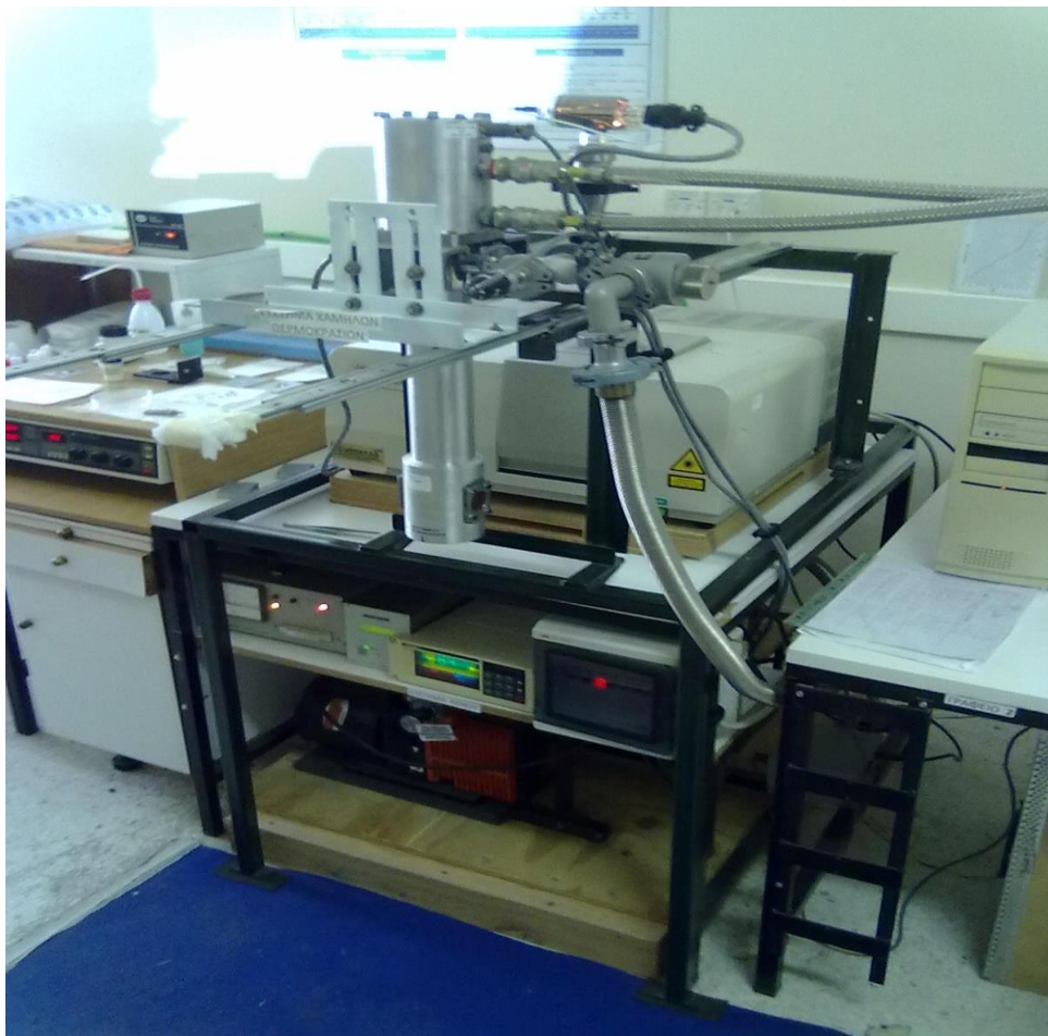
Σχήμα 3.1 : Φασματόμετρο FTIR Jasco 470 Plus με το σύστημα κρυοστάτη.
