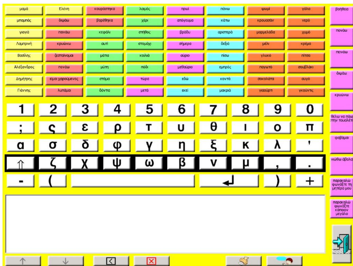
Σχήμα 81: Βοήθημα επικοινωνίας με Ελληνική φυσική γλώσσα και αυτόματη σάρωση μέσω ενός διακόπτη (χρήστης ΛΧ)
