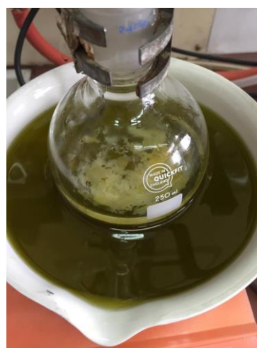
Εικόνα 21: Παρατηρείται πιο αναλυτικά η διαδικασία σαπωνοποίησης
