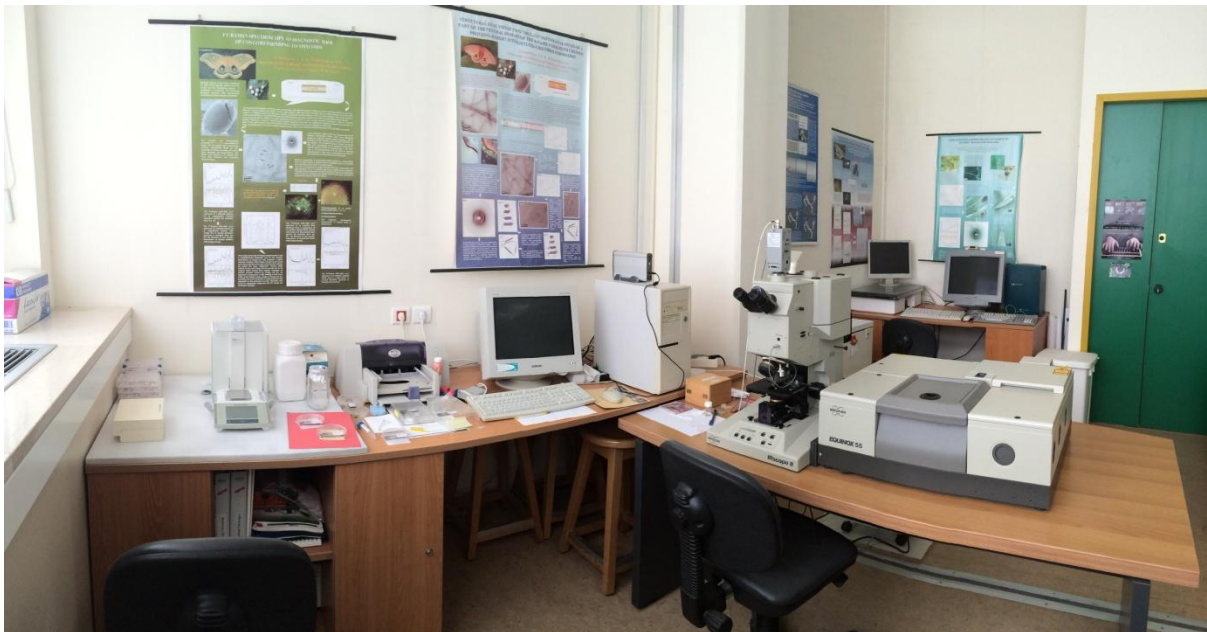
Εικόνα 73. Μικροσκοπίο υπερερυθρού IRScope II (BrukerOPTICS, Bruker Optik GmbH, Ettlingen, Germany) συνδεδεμένο με φασματοσκόπιο μετασχηματισμού Fourier Equinox 55 (BrukerOPTICS), στον Τομέα Βιολογίας Κυττάρου και Βιοφυσικής, του Τμήματος Βιολογίας, του Εθνικού και Καποδιστριακού Πανεπιστημίου Αθηνών.
