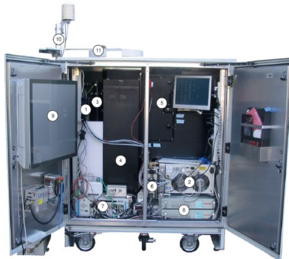
Σχήμα 7: Η καμπίνα που περιέχει τα διάφορα τμήματα του Raman lidar συστήματος Polly XT (1) κεφαλή laser, (2) παροχή ρεύματος laser, (3) επιμηκυντής δέσμης, (4) τηλεσκόπιο, (5) δέκτης με επτά κανάλια, (6) παροχή ρεύματος για τη μονάδα ψύξης του φωτοπολλαπλασιαστή στα 1064 nm, (7) υπολογιστής με κάρτα επίκτησης δεδομένων και κάρτα διεπαφής, (8) UPS, (9) μονάδα κλιματισμού, (10) αισθητήρες εξωτερικής θερμοκρασίας και βροχόπτωσης, (11) κάλυμμα οροφής
