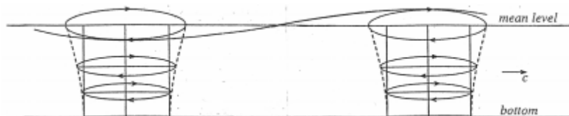
Γράφημα 3. Συμπεριφορά κυμάτων τσουνάμι σε ρηχά νερά καθώς αυτό πλησιάζει την ακτή. Πηγή (Brearley, 1970)
