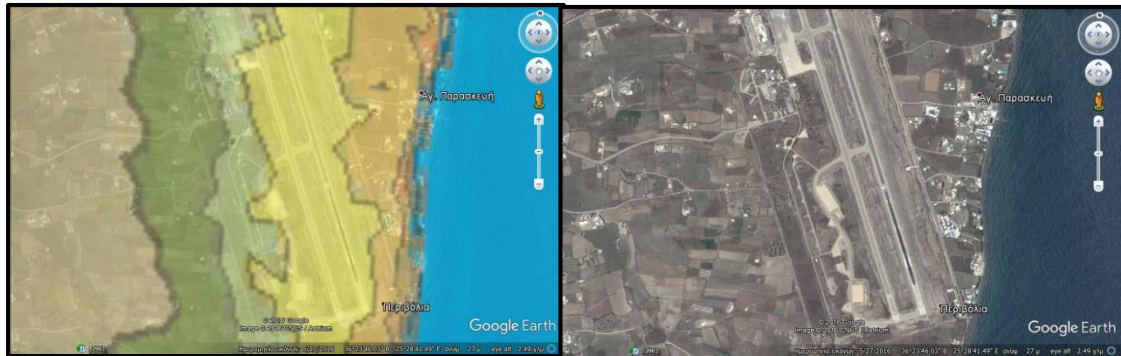
Εικόνα 26. Περιοχή αεροδρομίου Σαντορίνης. Εντός της ζώνης με τιμές 2 έως 5 μέτρα runup , είναι βασικές εγκαταστάσεις του αεροδρομίου.
