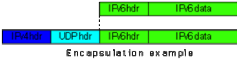
Σχήμα 21: Μηχανισμός Teredo. Ενθυλάκωση σε IPv4 UDP πακέτο
