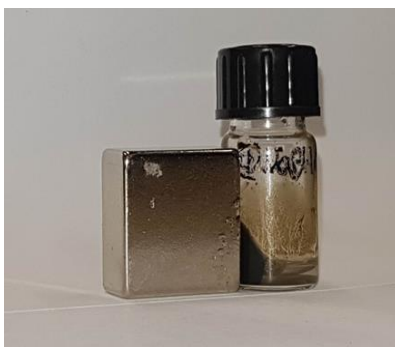
Εικόνα 31: Μαγνητική συμπεριφορά των νανοσωματιδίων οξειδίου του σιδήρου επικαλυμμένα με τρινάτριο άλατος του κιτρικού οξέος και βοροϋδρίδιο του νατρίου, παρουσία μόνιμου μαγνήτη (mNPs@NaBH 4 )
