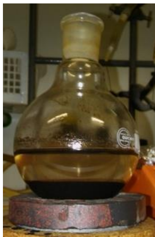
Εικόνα 25: Καθαρισμός νανοσωματιδίων μέσω μαγνητικού διαχωρισμού
