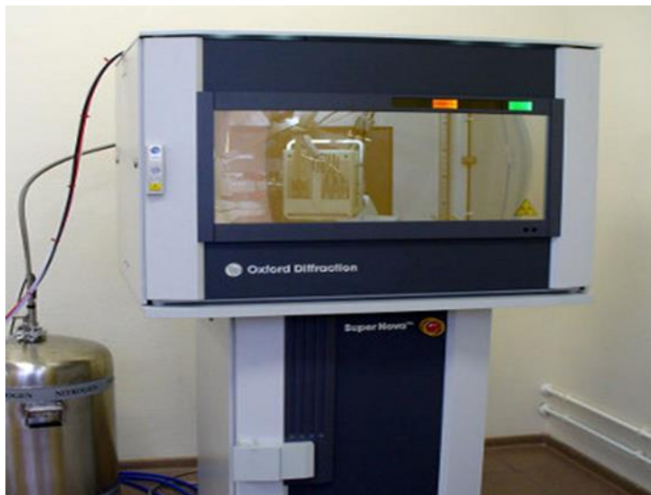
Εικόνα 19: X-ray diffractometer Agilent Technologies Super Nova, με το οποίο πραγματοποιήθηκαν οι μετρήσεις για την παρούσα ερευνητική εργασία.
