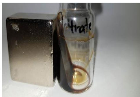
Εικόνα 29: Μαγνητική συμπεριφορά των νανοσωματιδίων οξειδίου του σιδήρου επικαλυμμένα με τρινάτριο άλατος του κιτρικού οξέος, παρουσία μόνιμου μαγνήτη (mNPs@citrato)
