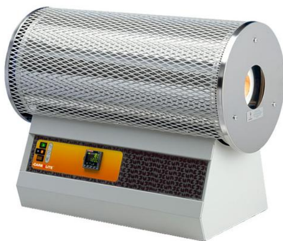
Εικόνα 2.2.1: Απεικονίζεται ο φούρνος, που χρησιμοποιήθηκε στην παρούσα εργασία. Το συγκεκριμένο μοντέλο είναι το Carbolyte τύπου TZF 12/65/550. Τα χαρακτηριστικά του μοντέλου είναι τα εξής: μήκος συσκευής 550mm, εσωτερική διάμετρος 65mm, μέγιστη ισχύς 2000W, βάρος 38kg.
