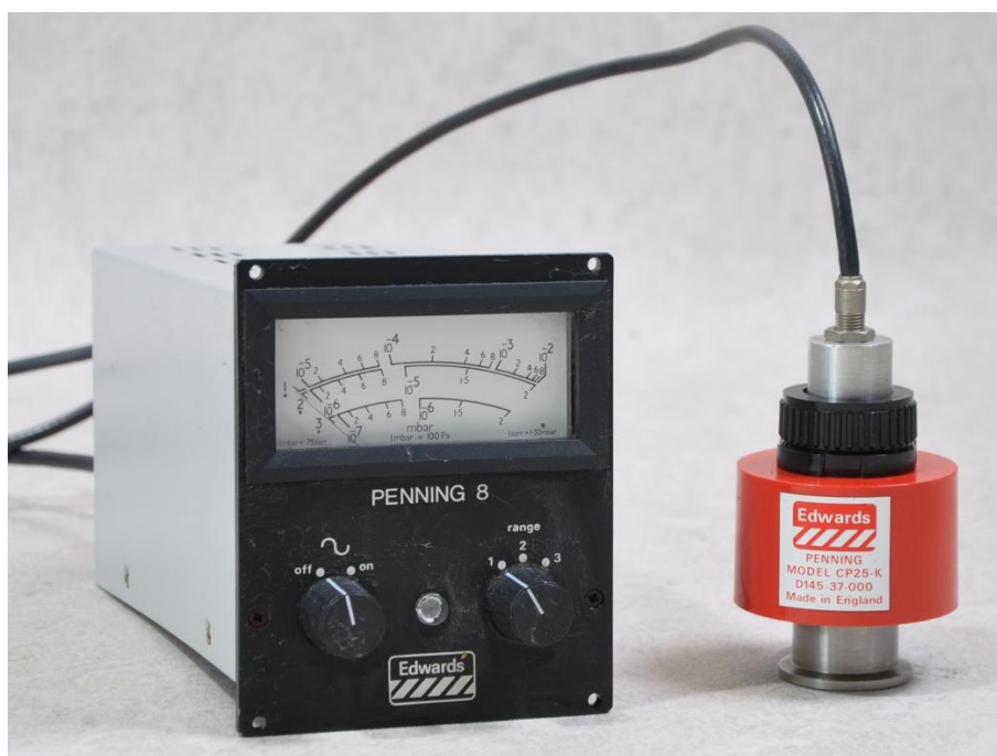
Σχήμα 2.4.2.2.2: Απεικονίζεται η συσκευή μέτρησης υψηλού κενού, που χρησιμοποιήθηκε στη λήψη μετρήσεων στην παρούσα εργασία. Το συγκεκριμένο μοντέλο είναι το Edwards Penning 8 και το Edwards Penning CP25-K ψυχρής καθόδου. Οι τεχνικές προδιαγραφές του είναι οι εξής: 240V, 50Hz, 15W.
