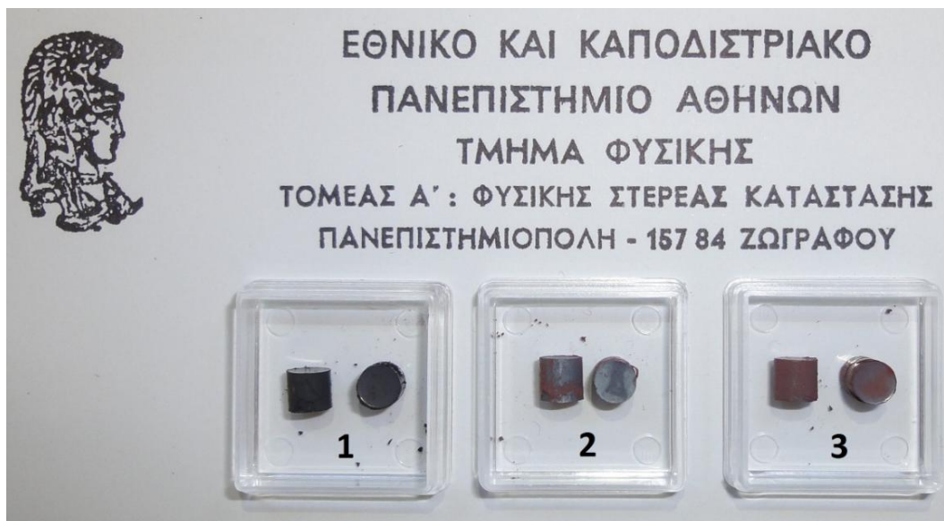
Εικόνα 2.8.1: Τρεις διαφορετικές παρασκευές δειγμάτων οξειδίων του σιδήρου, όπως παρουσιάζονται μετά τη διαδικασία της πυροσυσσωμάτωσης. Η πυροσυσσωμάτωση των δειγμάτων της παρασκευής 1 έγινε σε πίεση P=7 \cdot 10^{-5} \text{ mbar} , της παρασκευής 2 έγινε σε P=10^{-2} \text{ mbar} , της παρασκευής 3 έγινε σε P=10^3 \text{ mbar} .
