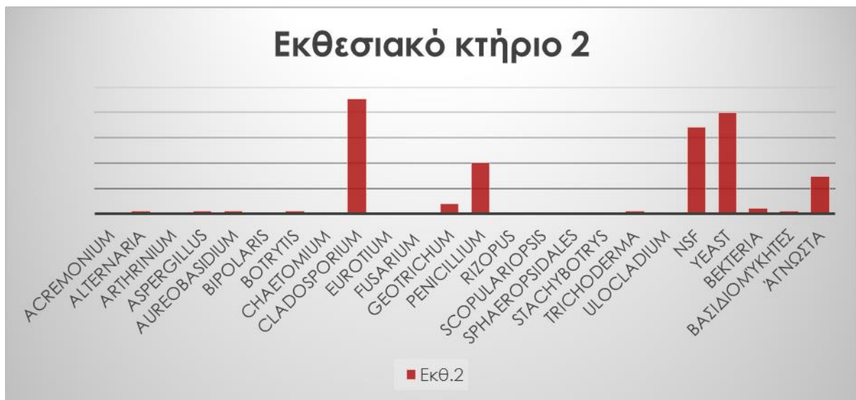
Διάγραμμα 90 Συγκέντρωση CFU/m3 ανά γένος μυκήτων στο σύνολο των δειγματοληψιών για το εκθεσιακό κτήριο 2.
