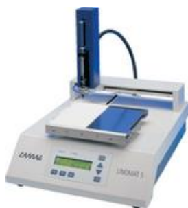
Εικόνα Β.10. Σύστημα CAMAG Linomat 5 με σύριγγα για την ομοιόμορφη εφαρμογή των δειγμάτων στις πλάκες με τη μορφή ψεκασμού
