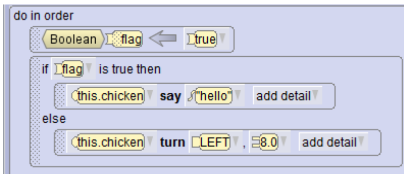
Εικόνα 7: Δημιουργία του μπλοκ If Με αυτό τον τρόπο δημιουργήσαμε μια δομή επιλογής.
