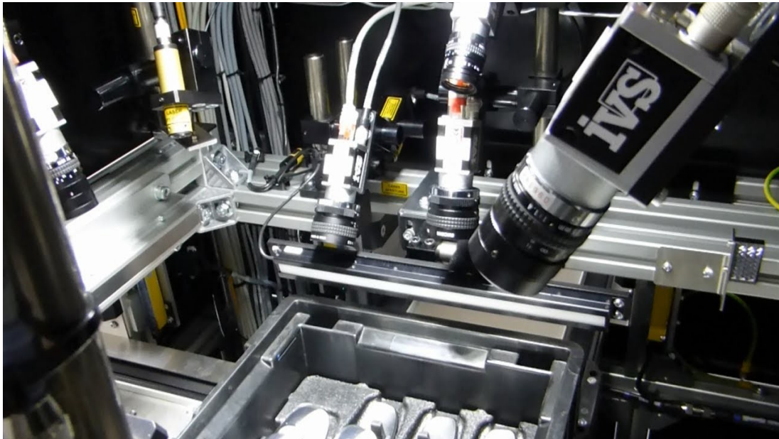
Εικόνα 1: Σύστημα μηχανικής όρασης πραγματοποιεί έλεγχο σε γραμμή παραγωγής
