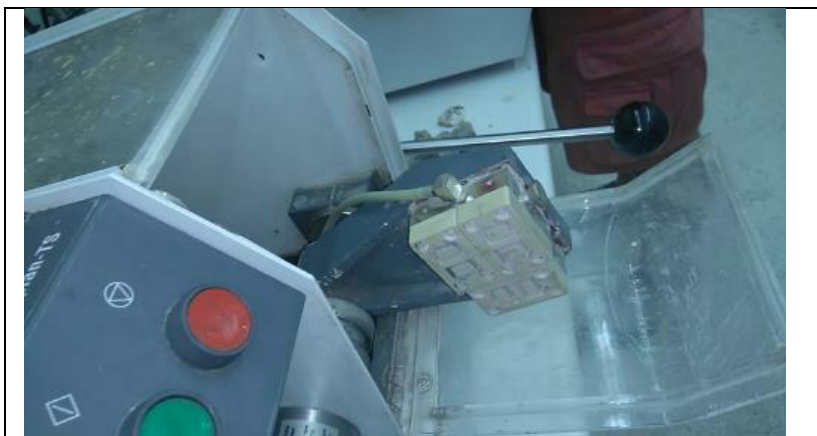
Συγκόλληση δειγμάτων με Discoplan-TS
