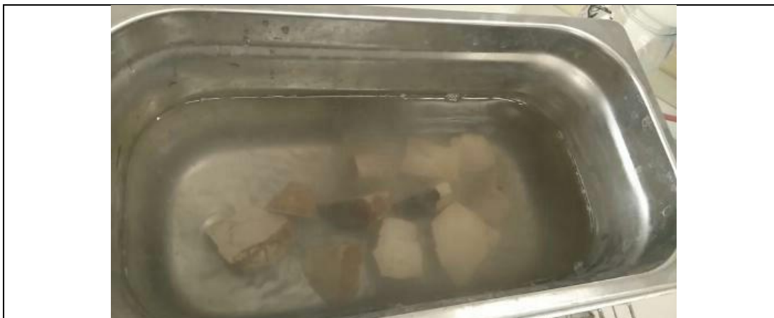
Τα καθαρά δείγματα καθαρίζονται ακόμα βαθύτερα με υπερήχους.
