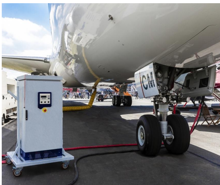
Εικόνα 22: GPU συνδεδεμένο με το ηλεκτρικό σύστημα αεροσκάφους.
