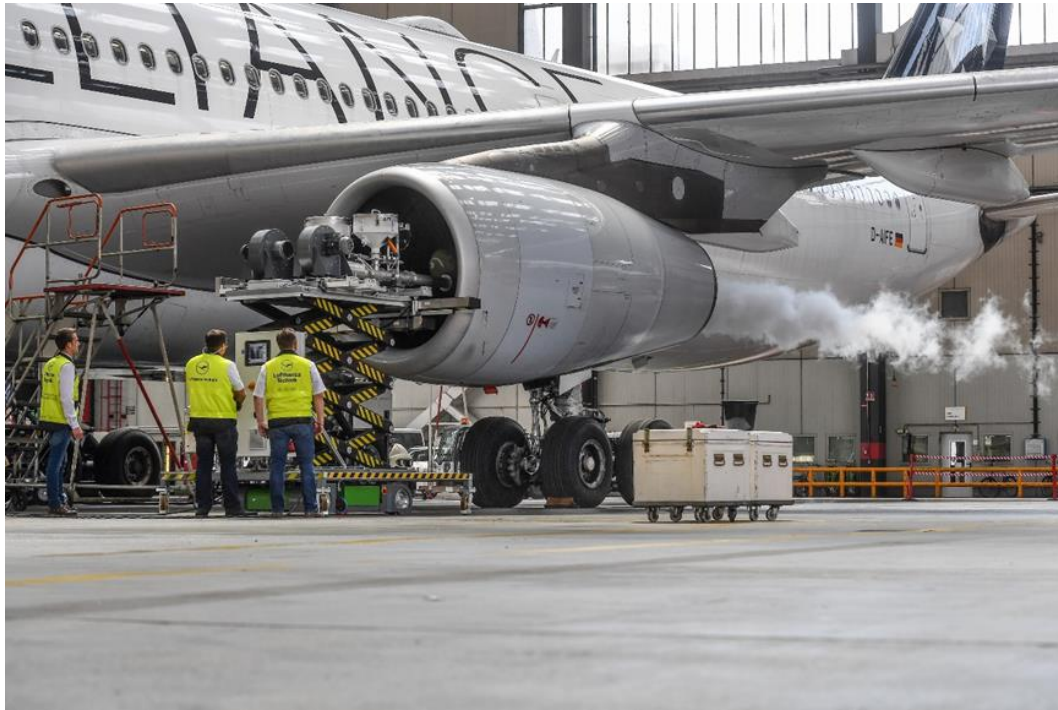
Εικόνα 21: Πλύσιμο κινητήρα με χρήση μεθόδου ξηρού πάγου.
