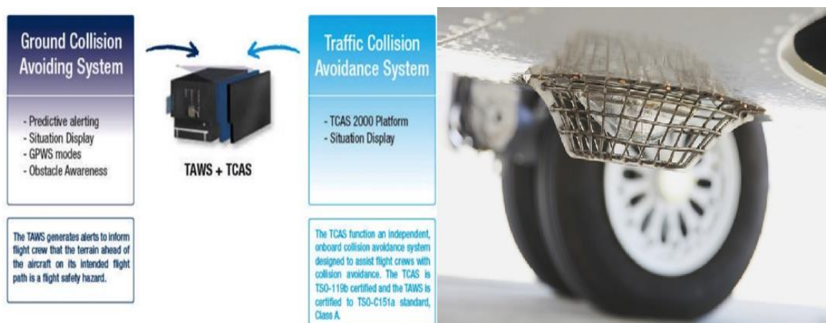
Εικόνα 23: Εισαγωγή TWAS & TCAS μέσω AD (αριστερά) και φωτο-προστατευτικό μέσω SB (δεξιά).
