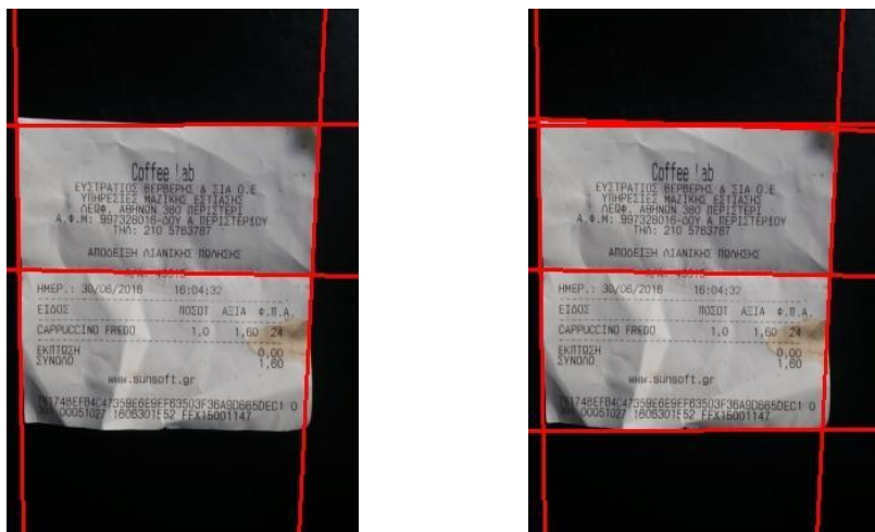
Εικόνα 65: Αριστερά το αποτέλεσμα της εφαρμογής της Hough_VP, δεξιά το αποτέλεσμα της Hough_Th
