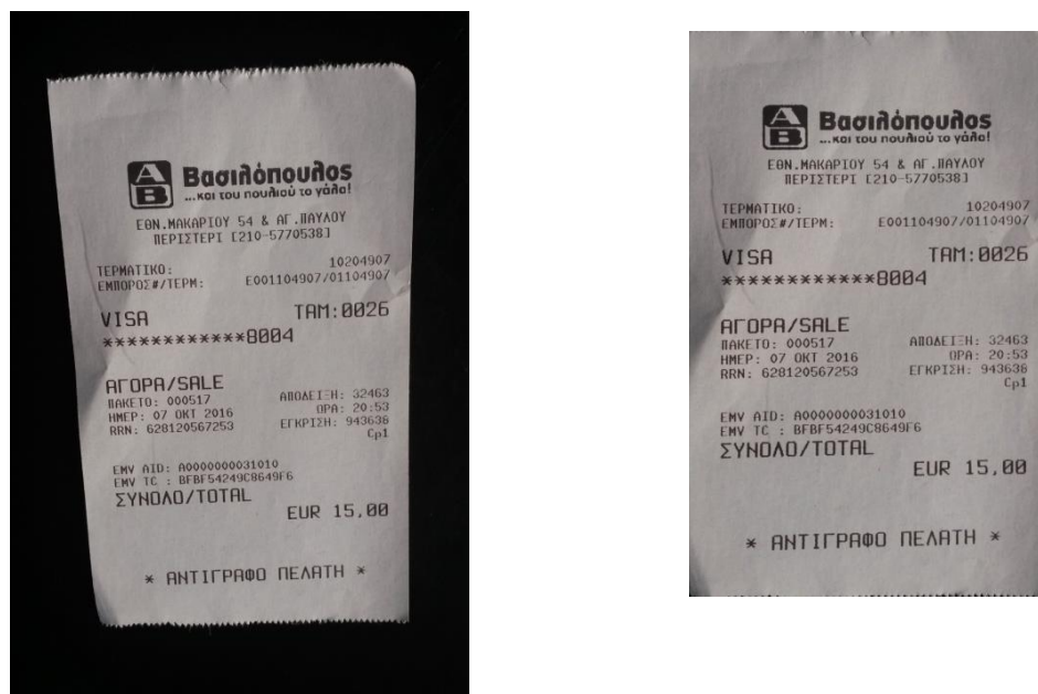
Εικόνα 51: Στάδιο διόρθωσης της προοπτικής παραμόρφωσης με την εφαρμογή προβολικού μετασχηματισμού (ομογραφίας). Στη δεξιά στήλη βρίσκονται οι αρχικές παραμορφωμένες εικόνες ενώ αριστερά οι τελικές
