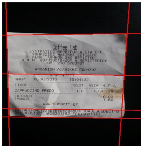
Εικόνα 49: Η δεξιά στήλη εικόνων παρουσιάζει την εύρεση ευθειών με τη χρήση τεσσάρων τοπικών μεγίστων (μέθοδος 2) και η αριστερή στήλη απεικονίζει την επιλογή ευθειών με τη χρήση της κατωφλίωσης.
