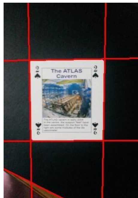
Εικόνα 62: Hough_Th σωστή ανίχνευση ευθειών
