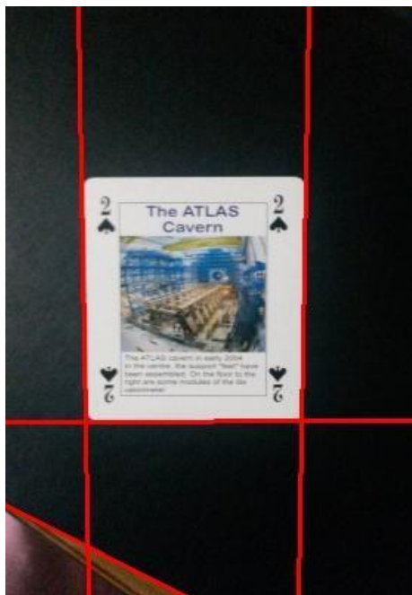
Εικόνα 61: Hough_VP λανθασμένη ανίχνευση ευθειών
