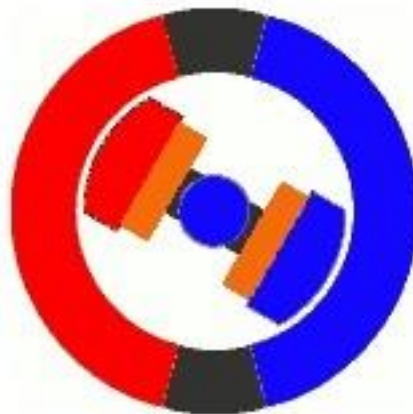
Εικόνα 72: Κίνηση κινητήρα με απώθηση ηλεκτρομαγνήτη [63]
