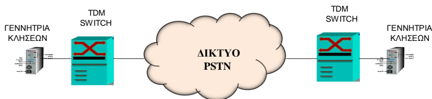
Σχήμα 32 : Η τοπολογία του δικτύου PSTN
