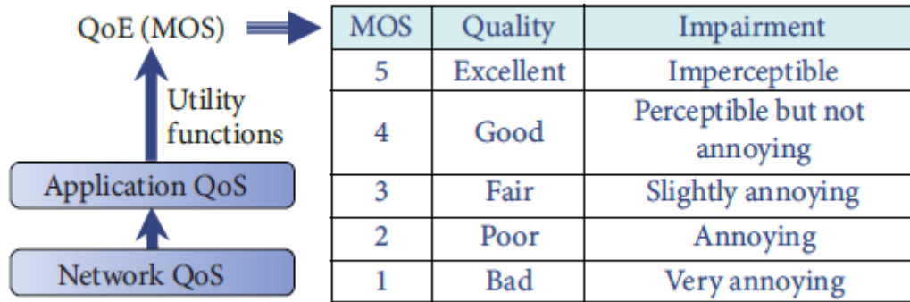
Εικόνα 30: Προσέγγιση bottom up για τον υπολογισμό του QoE και ερμηνεία του MOS ως προς την ποιότητα που αντιλαμβάνεται ο χρήστης.
