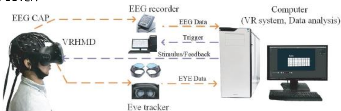
Εικόνα 9: Διάγραμμα στοιχείων (component mapping) του συστήματος πληκτρολόγησης με SSVEP BCI και HMD VR.
