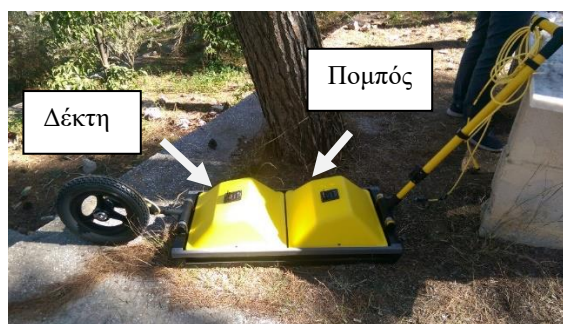
Εικόνα 11 . Το όργανο GPR ή Γεωραντάρ που χρησιμοποιήθηκε για την διεκπεραίωση της μελέτης.
