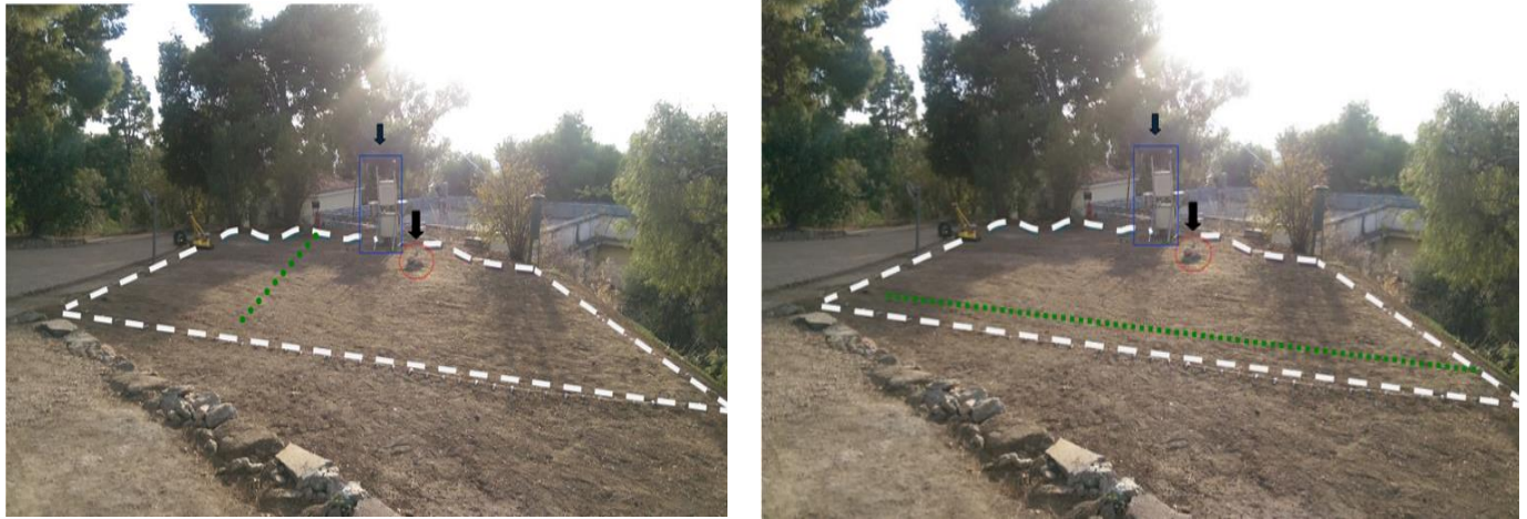
Εικόνα 18. Ενδεικτικά με την πράσινη γραμμή η τοποθέτηση στο πεδίο ενός κάθετου προφίλ σάρωσης (κάθετη τομή) (Εικ.α ) και ενός οριζόντιου προφίλ σάρωσης (οριζόντια τομή) (Εικ.β ). Διεξαγωγή πολλαπλών κάθετων (κατά τον άξονα y ) και οριζόντιων (κατά τον άξονα x ) σαρώσεων.
