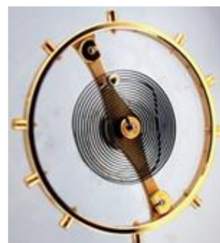
Εικόνα 4.5: Το balance, συνοδευόμενο από την τρίχα στο κέντρο του.
