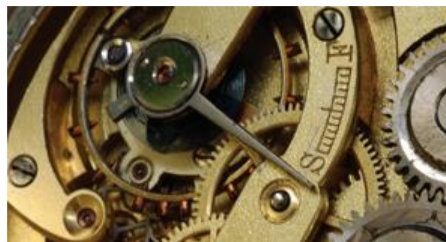
Εικόνα 5.4: Το «τιμόνι» που ρυθμίζει την «ταχύτητα» του ρολογιού.
