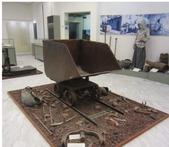
Εικόνα 7 Κουρμπαδόρος Γραμμών, εργαλείο που λύγιζε τις σιδηροτροχιές προκειμένου να τους δώσει την κατάλληλη ακτίνα καμπυλότητας, αναπαράσταση εργαλείων στο εσωτερικό του Μεταλλευτικού Μουσείου.
