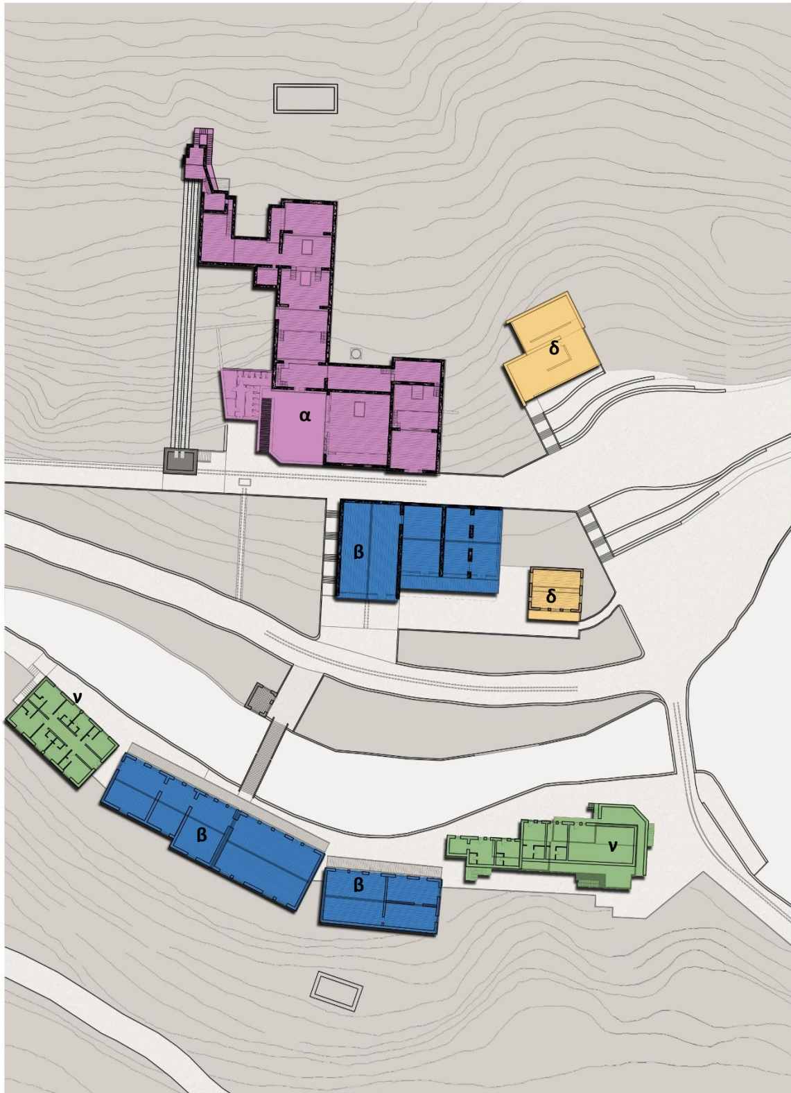
Σχέδιο 33: Διάγραμμα χρήσεων του βιομηχανικού συγκροτήματος των Θεωρυχείων, όπου διακρίνεται ο χώρος του εργοστασίου (α), οι βοηθητικοί χώροι (β), οι χώροι διαμονής (γ) και οι χώροι εστίασης (δ).
