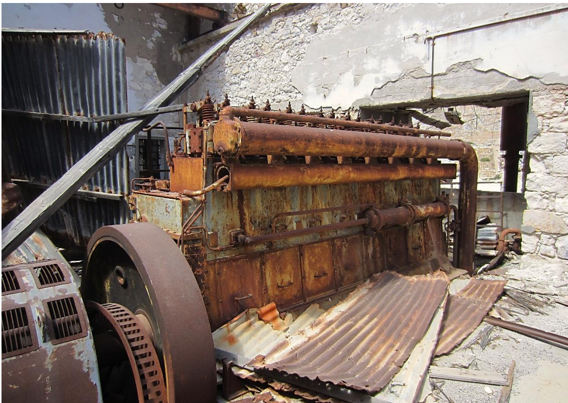
Εικόνα 34: Μηχανή MAN στο εσωτερικό του Μηχανοστασίου, για την παραγωγή ενέργειας, φωτ. προσωπικό αρχείο γράφουσας.
