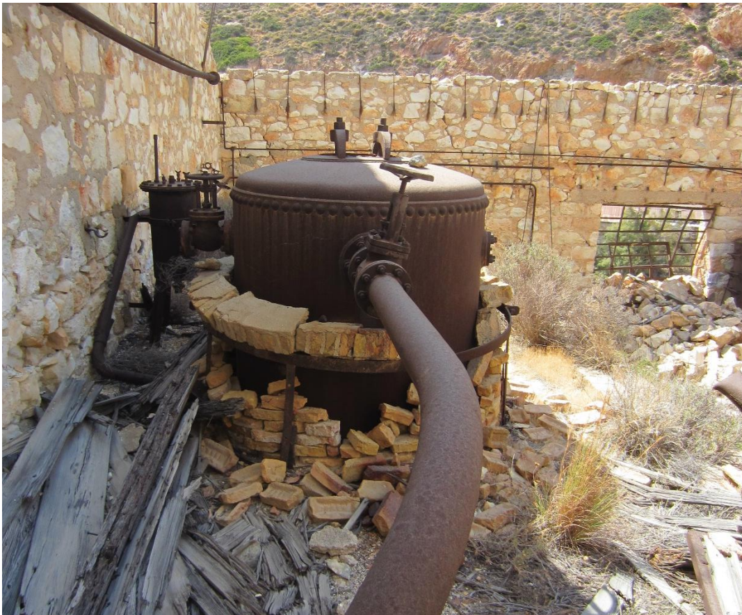
Εικόνα 46: Ατμολέβητας για την παραγωγή ατμού, απαραίτητου στην επεξεργασία του θείου, φωτ. προσωπικό αρχείο γράφουσας.
