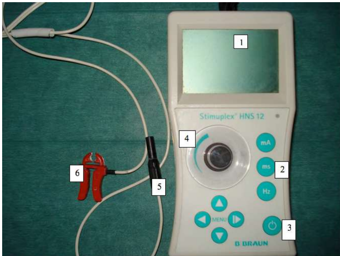
Εικόνα 5: Απεικονίζεται ένας τυπικός νευροδιεγέρτης: B-Braun Stimuplex HNS12 9
