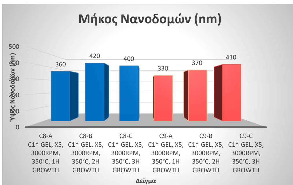
Γράφημα 1: Μήκος των νανοδομών CuO υποστρώματος Si (μπλε χρώμα) και SiO 2 (κόκκινο χρώμα) σε διαφορετικούς χρόνους υδροθερμικής ανάπτυξης.
