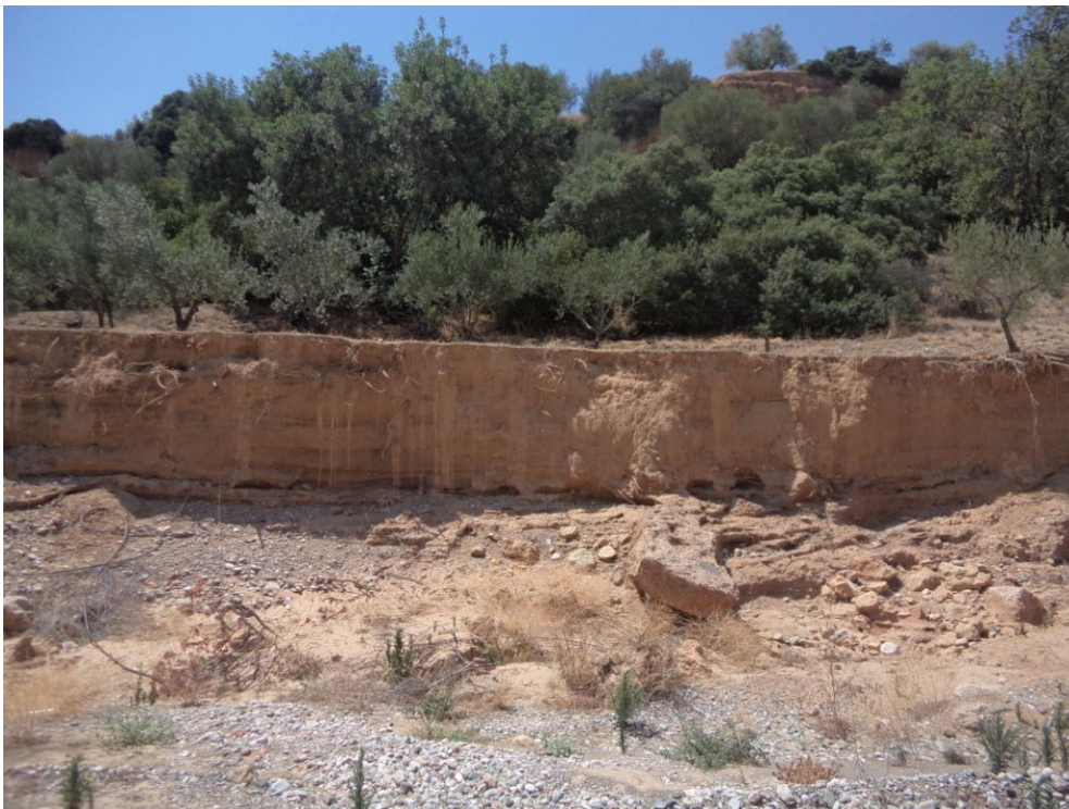
Εικόνα 2.2.1.3:Επιτόπια έρευνα και λήψη φωτογραφικού υλικού . Πάνω η δεξιά αναβαθμίδα του Μαριορέματος στο σημείο της ιρλανδικής διαβασής του δρόμου από Μυρτιά (κατάντη του μαιάνδρου) με εναλλαγές αδρομερών και λεπτομερών υλικών από παλιότερα πλημμυρικά επεισόδια. Κάτω: η δεξιά όχθη του μαιάνδρου που υπέστη σημαντική υποχώρηση (διάβρωση) κατά το πλημμυρικό επεισόδιο του 2016.
