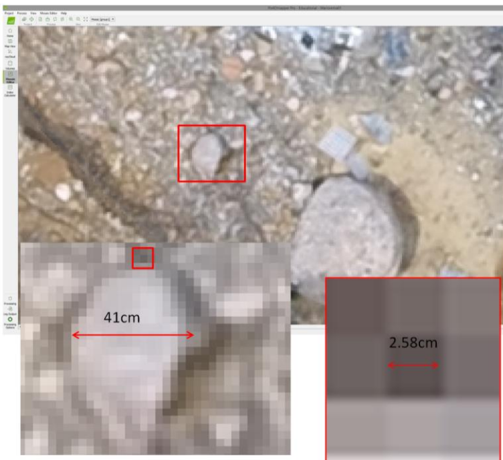
Εικόνα 2.3.6 Δυνατότητα υψηλής ανάλυσης. Πάνω: μεγέθυνση του ορθομωσαϊκού σε επίπεδο παρατήρησης μορφολογικών μεταβολών (κόκκινο πλαίσιο: όριο υποχώρησης όχθης από διάβρωση, κίτρινο πλαίσιο: απόθεση ογκολίθου σε χώρο με αδρομερή υλικά). Κάτω: μέγιστη ανάλυση του ορθομωσαϊκού σε επίπεδο παρατήρησης κοκκομετρίας: κόκκινο πλαίσιο).
