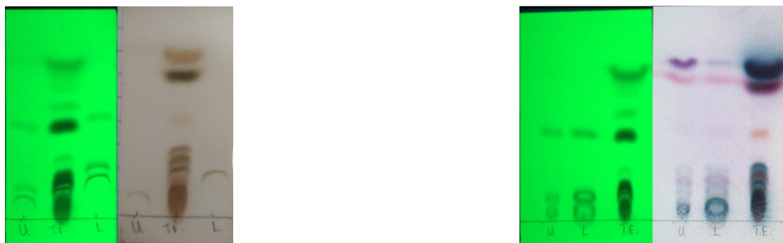
Εικόνα 15: Έλεγχος διφασικών συστημάτων με TLC. Αριστερά τα χρωματογραφήματα της πάνω και κάτω φάσης για το σύστημα n -Hex/ACN/Butanol -> 1,6/1,6/0,2 και δεξιά τα αντίστοιχα χρωματογραφήματα για το σύστημα n -Hept/ACN/ iso -propanol-> 1,6/1,6/0,2. Κινητή φάση: DCM/ c -Hex-> 50/50. Παρατήρηση χρωματογραφήματων στα 254 nm και στο ορατό(Vis) μετά από ψεκασμό με διάλυμα θειϊκής βανιλίνης και θέρμανση.
