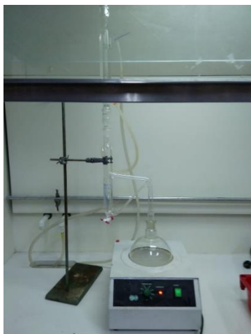
Εικόνα 10: Η συσκευή απόσταξης Clevenger κλειστού κύκλου
