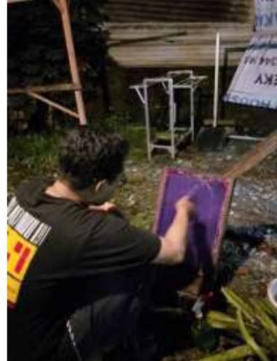
**Gambar 5.** Proses penyemprotan klise pada screen menggunakan air.
