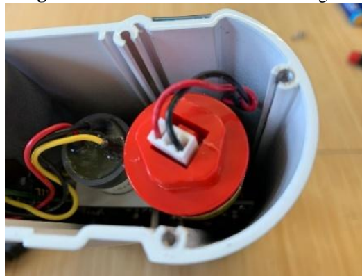
Figura 50. Sustitución del sensor de oxígeno
