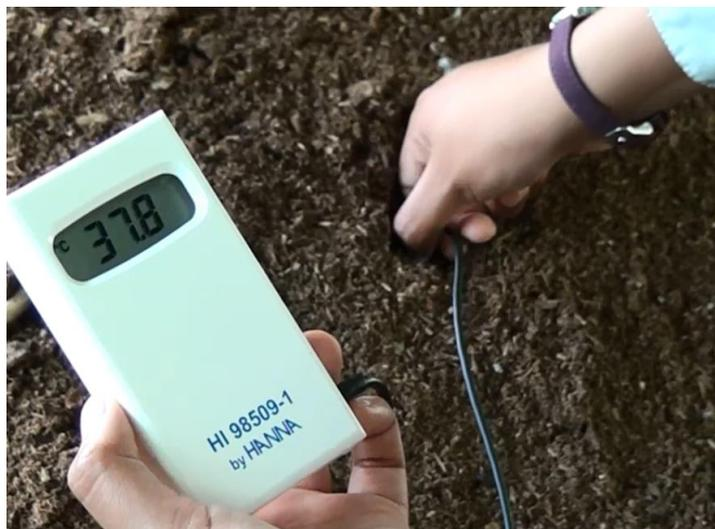
***Ilustración 82: Medición de la temperatura del lote***
