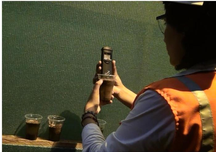
***Ilustración 11: Medición del pH***
