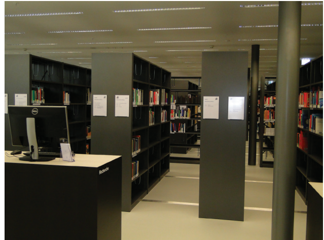
Abb. 12: Modulare Planung: In den Boden versenkte Schienen im Freihandbereich (Foto: S. Wanke)
