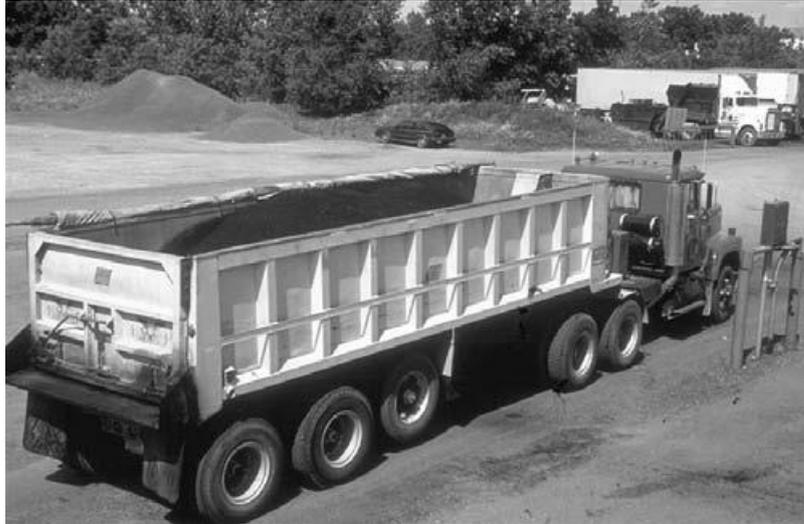
Figura 16 Transporte de mezcla asfáltica
