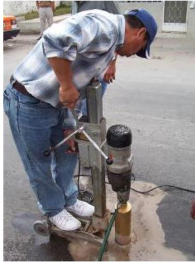
Figura 19 Extracción de un espécimen para obtener espesor y compacidad
