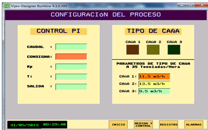
Figura 5. Visualización de medición y control del caudal de agua de imbibición en el programa Vijeo Designer v6.1
