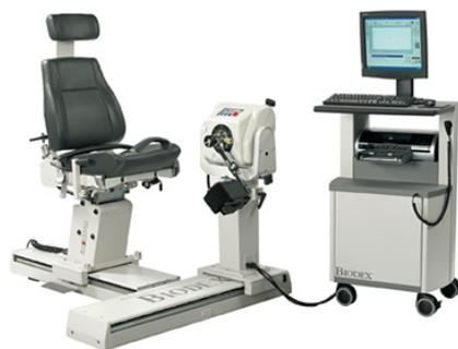
**Abbildung 8: Biodex isokinetic dynamometer System 4**
