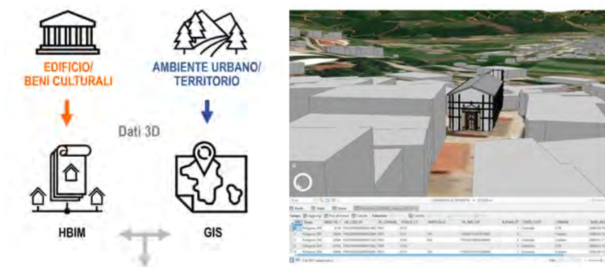
Figura 15 Importazione del modello BIM della Chiesa di San Lorenzo a Norcia in ambiente GIS (ArcGIS Pro).
