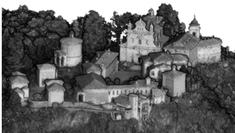
Figura 7 Nuvola di punti del Sacro Monte di Varallo – riflettanza.
