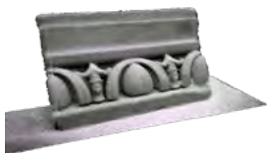
Figura 3 Nuvola di punti di un apparato decorativo.
