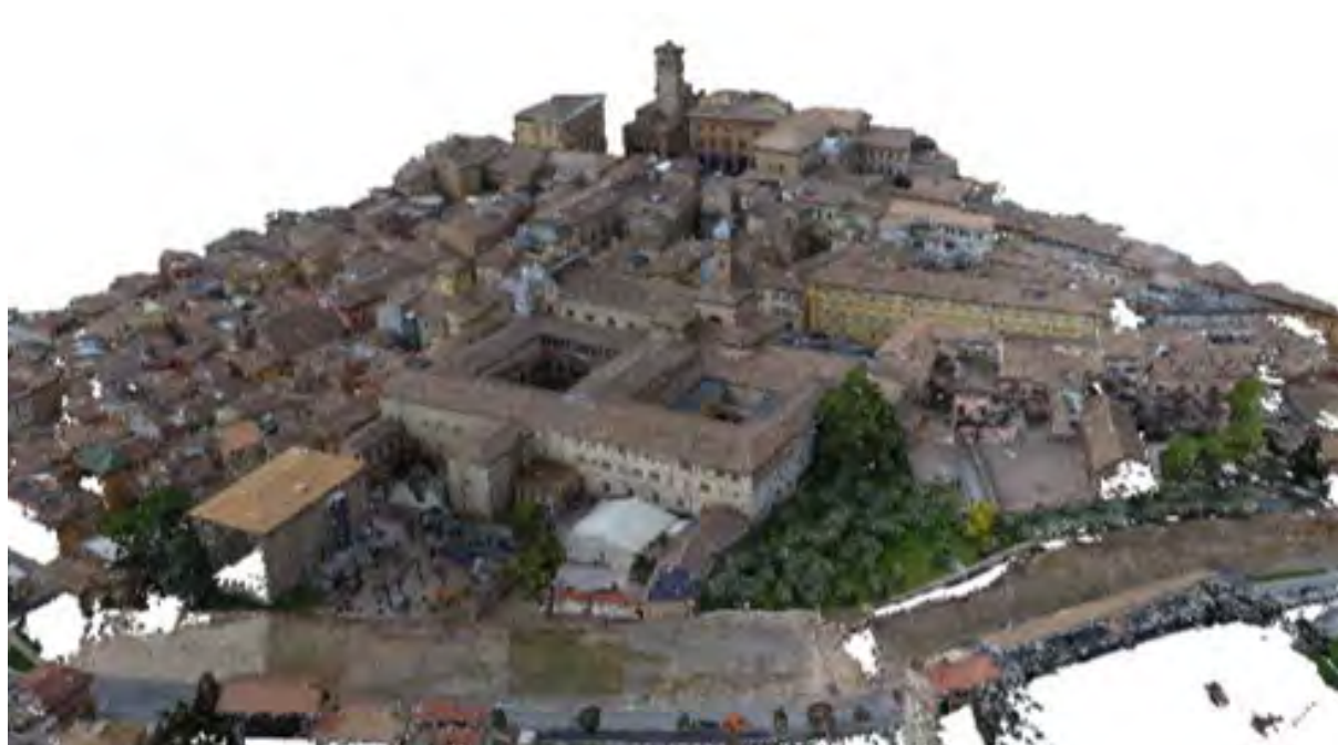
Figura 4 Nuvola di punti del Comune di Tolentino (MC) e della Basilica di San Nicola.
