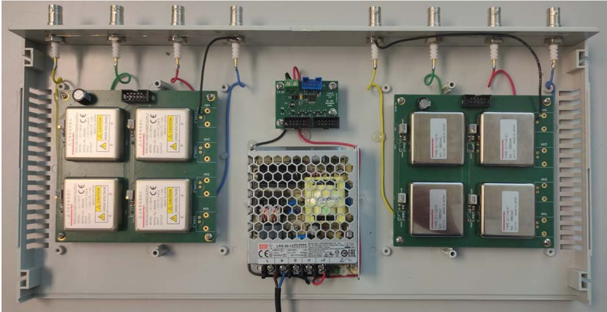
Figura H.4: Vista superior de la caja con las dos PCBs montadas con los 8 módulos HV Hamamatsu C11152-01.
