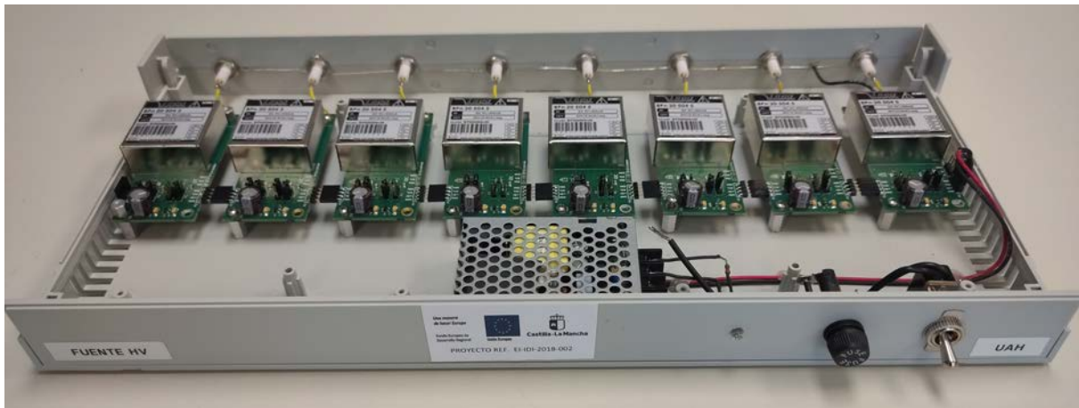
Figura 5.26: Arriba imagen del módulo de alimentación de 8 salidas HV con 8 fuentes hamamatsu. En la fotografía inferior el implementado con 8 fuentes iSeg.
