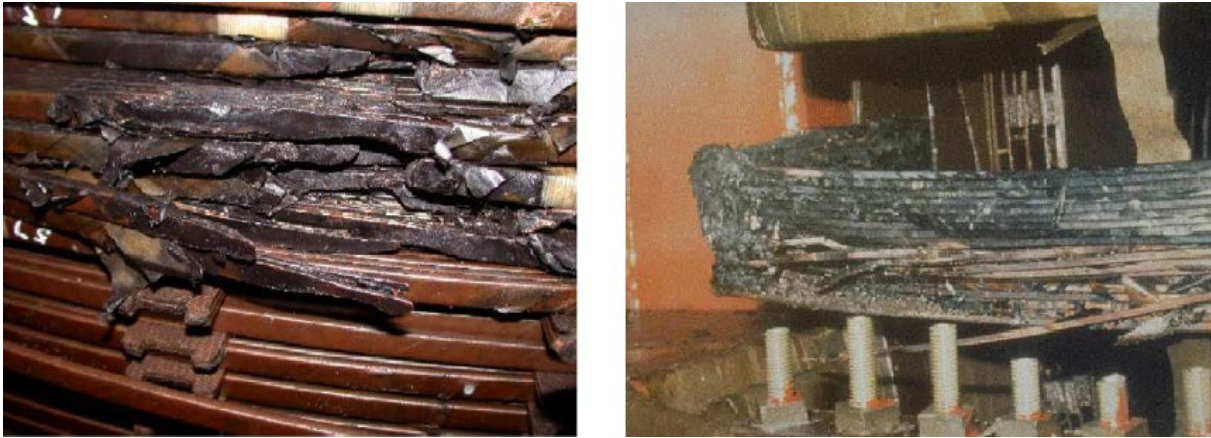
Figura 1.8: Bobinados de transformador quemados en centrales de energía eléctrica debido a tormentas geomagnéticas en Sudáfrica (2003) y en Canadá (1989). Imágenes obtenidas de Kappenman 2010a y Kappenman 2010b.
