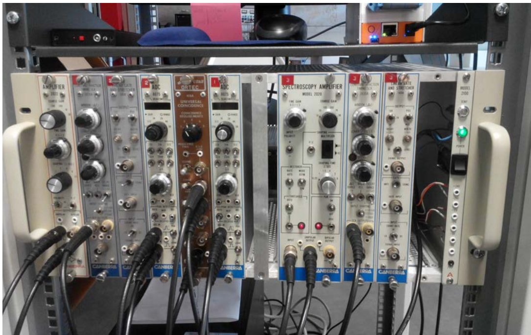
Figura 1.32: Montaje de módulos NIM para toma de datos en un telescopio de muones en las instalaciones del Monitor de Neutrones de Castilla la Mancha (CaLMa). Arriba, a la derecha, en naranja, puede observarse la caja del sistema de adquisición de datos para cadenas NIM desarrollado por el autor.
