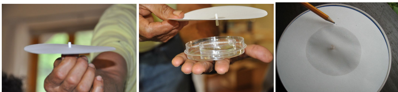
Figura A6. Pasos para la impregnación de la solución de \text{AgNO}_3 en el papel de filtro
