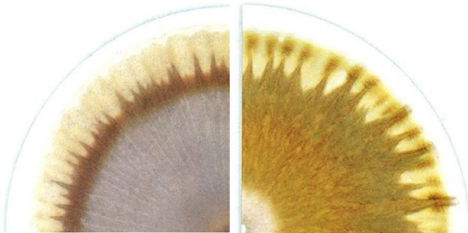
Figura A16. Cromatogramas mostrando presencia de manchas en la zona húmica (derecha) y ausencia de manchas (izquierda).
