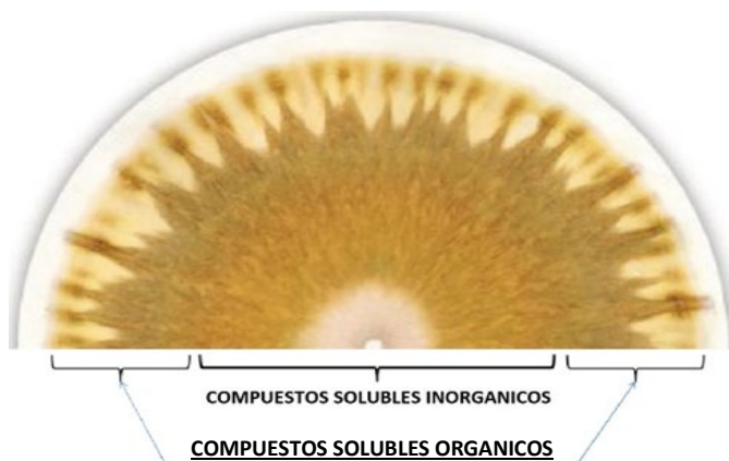
Figura A7. Desplazamiento de partículas en el papel de filtro dependiendo de la naturaleza de los componentes en la solución
