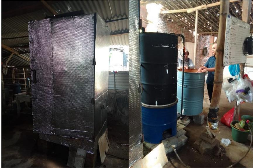
**Gambar 3.** Rangkaian alat integrasi *steam sterilization* dan *blanching*
