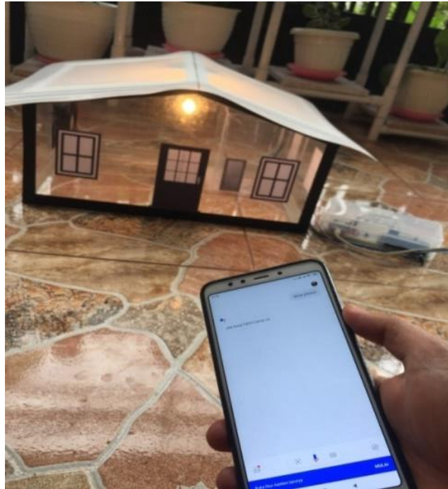
Gambar 5. Hasil pengujian perangkat listrik yang dikontrol menggunakan perintah suara
