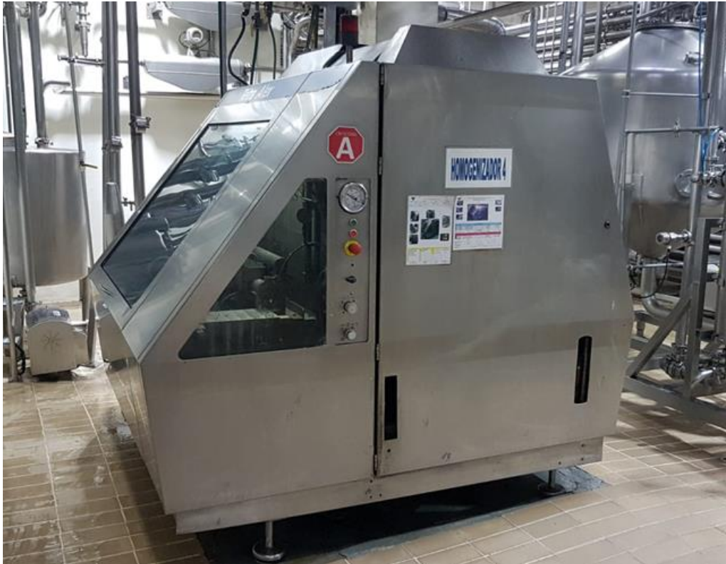
Figura 4 Homogeneizador Tetra Alex 400.
