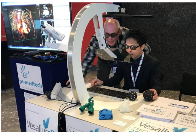
図 1B. 実際の操作: ユーザーは鏡面に投影された 3D ディスプレイの画像を見ながら、空間情報を認識するトラックボールで VR 画像を直接操作・計測する。
