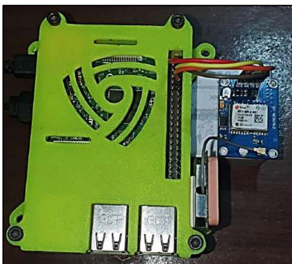
Ilustración 6-3: Conexión raspberry Pi y GPS NEO 6-m
