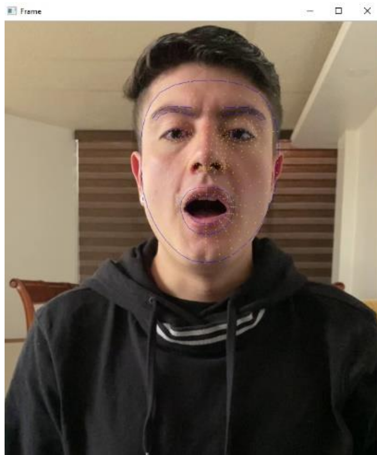
Figura 15-3: Puntos de malla y líneas de contorno
