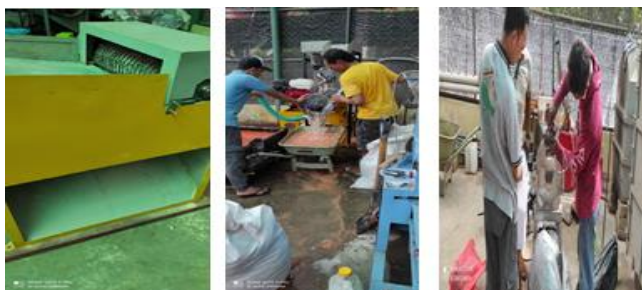
Gambar 5. Pemeliharaan peralatan setelah digunakan dengan cara membersihkan serpihan batang sagu pada mesin perontok, mencuci dengan air mengalir pada mesin ekstraktor, dan mengencangkan baut mesin penepung tepung sagu.
