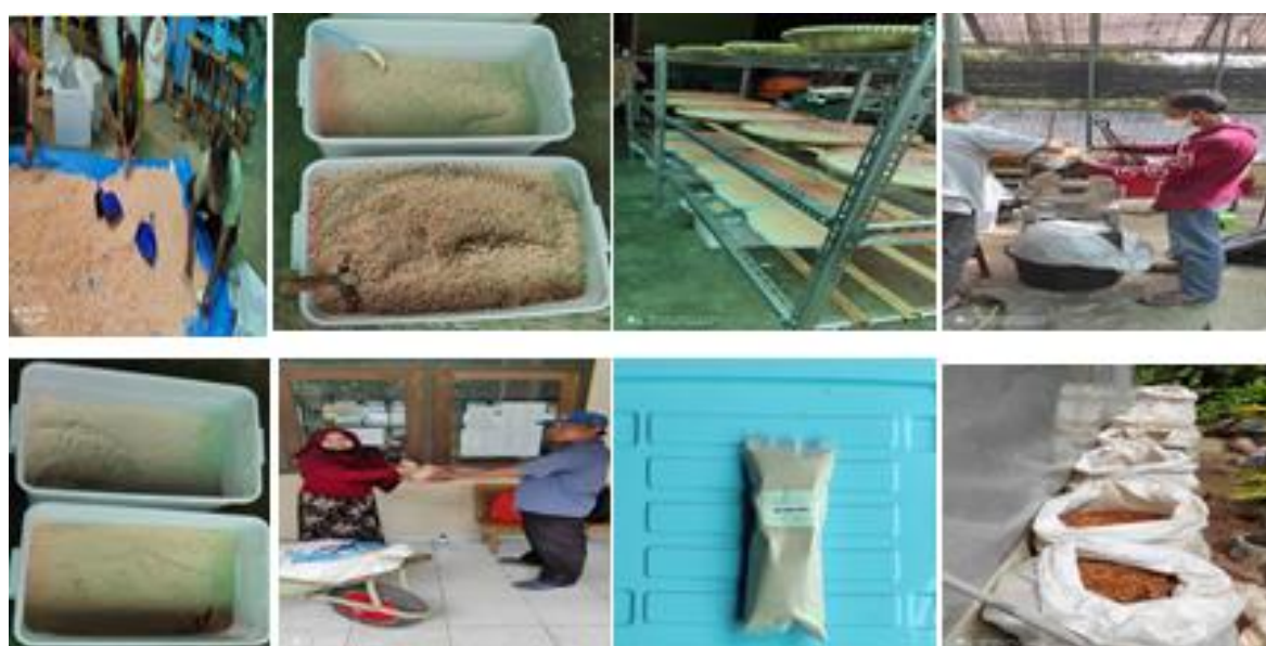
Gambar 4. Tepung sagu basah setelah di press dikeringkan dan ditepungkan (Gambar atas kiri–kanan). Tepung sagu kering yang tidak digiling langsung dipasarkan dan yang digiling dikemas untuk dipasarkan di supermarket. Nampak limbah padatan hasil proses satu batang pohon sagu (Gambar bawah, kiri–kanan).
