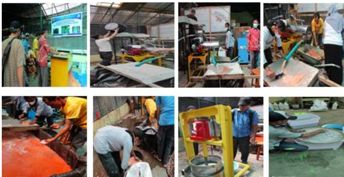
Gambar 3. Peserta melakukan perontokan batang sagu, hasil rontokan diekstrak (Gambar atas kiri–kanan). Hasil ekstrak diendapkan, tepung sagu basah dimasukkan ke dalam karung plastic, di press untk mengurangi kadar air dan selanjutnya di jemur (Gambar bawah, kiri–kanan).
