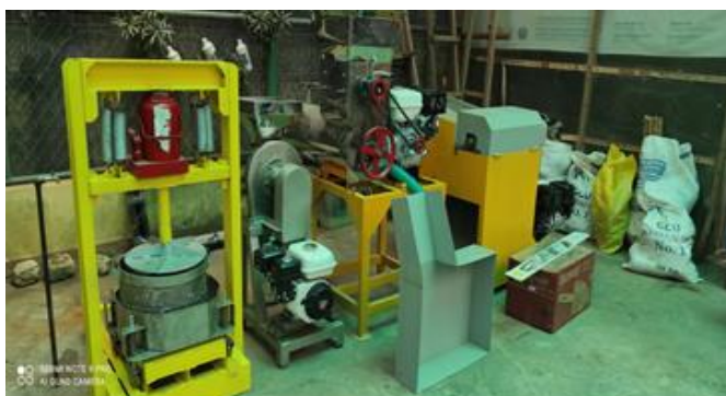
Gambar 1. Mesin pengolah sagu, terdiri dari mesin pengepres tepung sagu basah, mesin penepung, mesin ekstraktor rontokan batang sagu, mesin perontok batang sagu dan gergaji mesin ( saw mill ).
