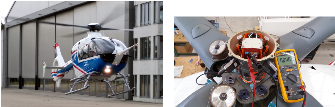
(a) Forschungshubschrauber ACT/FHS des DLR (b) Signalverarbeitungseinheit der Rotormessanlage Abbildung 6.19.: Der Forschungshubschrauber ACT/FHS sowie Teile der verbauten Rotormessanlage
