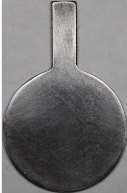
Figura 24. Muestra de acero DP590 maquinada.
