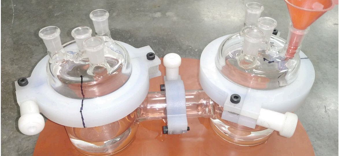
Figura 36. Celda ensamblada con los clamps de Nylamid.
