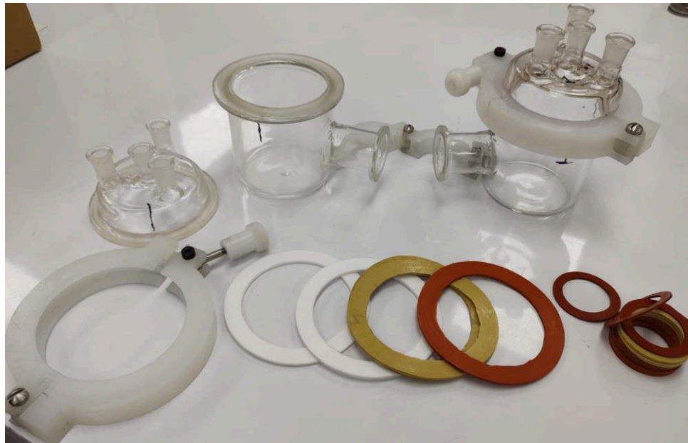
Figura 37. Clamps y empaques ya fabricados junto con las celdas.
