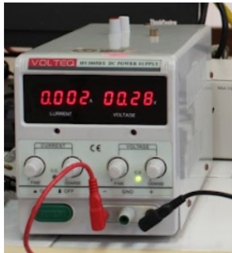
Figura 28. Fuente de poder marca Volteq, utilizada para la celda de carga.
